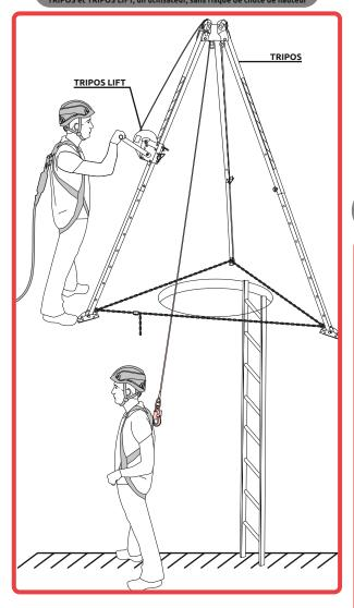
TRIPOS and two COBRA LIFT, two users, with risk of falling from a height TRIPOS e due COBRA LIFT, due utilizzatori, con rischio di caduta dall'alto TRIPOS et deux COBRA LIFT, deux utilisateurs, avec risque de chute de hauteur
